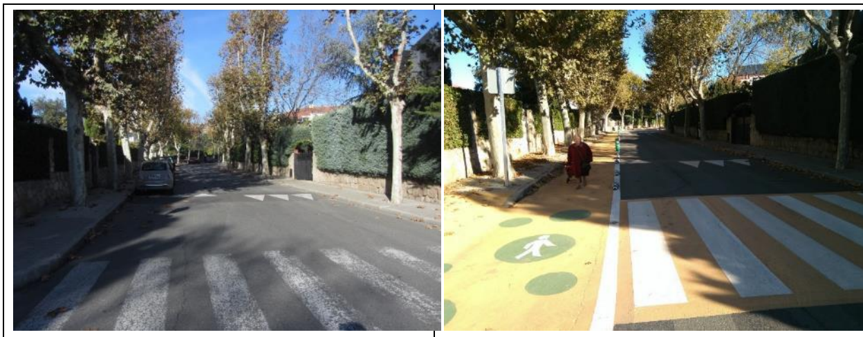
FOTO 18: ANTES Y DESPUÉS DE LA REALIZACIÓN DE UN ITINERARIO PEATONAL ACCESIBLE CON INTERVENCIONES DE BAJO COSTE (TORRELODONES)
